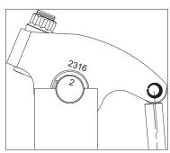
THE ROLLER WILL SWEEP FURTHEST SLIGHTLY PAST HALF LIFT
