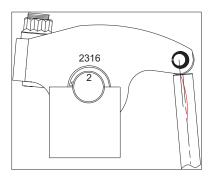
THE ROLLER SHOULD START .045" BEHIND CENTER AT ZERO LASH
