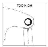
ROLLER PAST CENTER AT ZERO LASH INDICATES THE STAND NEEDS TO BE LOWERED OR A LONGER VALVE IS NEEDED.
