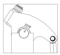
AT FULL LIFT, THE ROLLER SHOULD BE BACK AT CENTER
