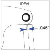
WHEN THE STAND HEIGHT IS SET CORRECTLY, THE ROLLER SHOULD BE APPROXIMATELY .045" BEHIND CENTER
