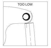
ROLLER ON THE BACK EDGE OF THE VALVE AT ZERO LASH INDICATES THE STAND NEEDS TO BE RAISED OR A SHORTER VALVE IS NEEDED.
